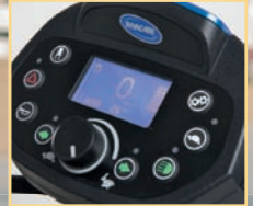
Kurvensteuerung für geringere Geschwindigkeit in der Kurve
