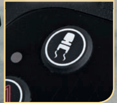
Kurvensteuerung für geringere Geschwindigkeit in der Kurve
