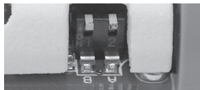
Abbildung (10) 2 DIP-Schalter zur Einstellung der Tonfrequenz
