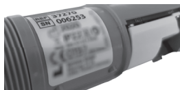
Rysunek (8) Tabliczka znamionowa ze wszystkimi cechami identyfikacyjnymi
