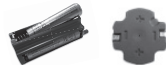
Slika (3) Vstavljanje akumulatorske baterije
