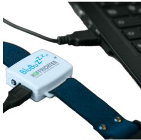
Abbildung 10: Micro-USB-Kabeleingang
